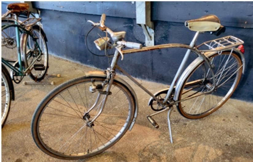
Figure 13. Super-Stella Pax, modèle homme sport de 1945, avec équipement de luxe. Il présente, également un cadre aérodynamique en double tubes de 16 mm. © SEB.
