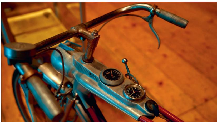
Figure 11. Vue du carter en aluminium avec phare et tableau de bord intégré. Aero-Stella modèle 1940. © SEB.
